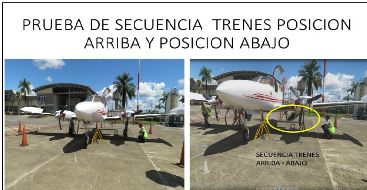
Fotografía No. 8: Pruebas operacionales del sistema de tren
