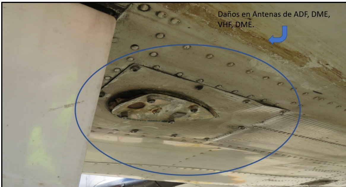
Fotografía No 3: Daños en antenas de navegación y comunicación.
